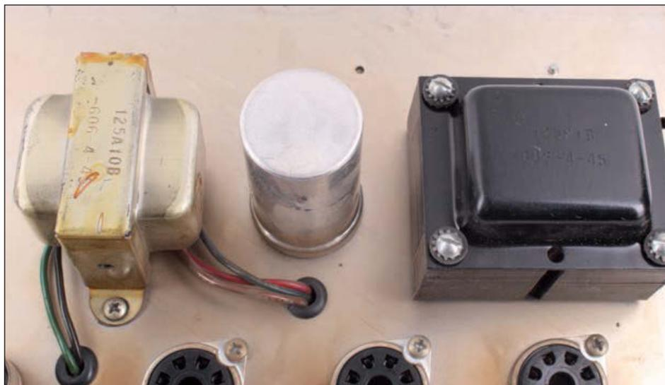
gen. Die Transformatoren kaufte Fender von Woodward-Schumacher aus Chicago zu. Einen Stand-By Schalter sucht man auf dem Backpanel vergeblich, aber die 5AR4 Gleichrichterröhre sorgt ohnehin für ein langsames Hochfahren. Im Inneren des Combos sitzt ein schwarzer Jensen C10R, ein 10" Lautsprecher mit Keramikmagnet und einer nominalen Belastbarkeit von rund 12 Watt, was beim Annähern an die Crunch-Schwelle grenzwer-
