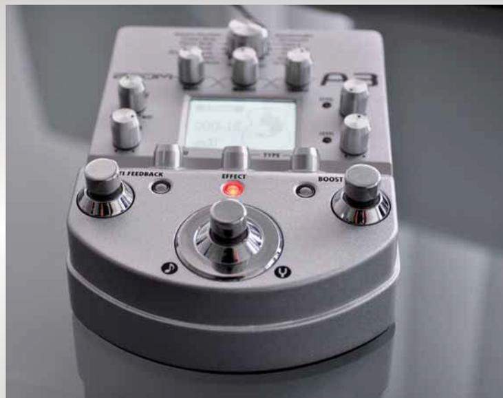
Die robusten Fußtaster und das Metallgehäuse sehen nicht nur edel aus; die drei hinterleuchteten Buttons bieten Zugriff auf die jeweiligen Parameter-Einstellungen (Anti-Feedback, Effect, Boost)
