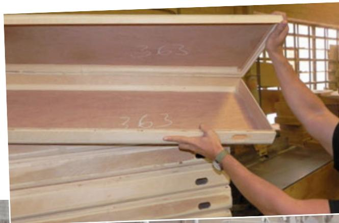
Zuerst wird eine geschlossene Holzkiste gebaut, die erst später in Deckel und Unterteil zersägt wird.
